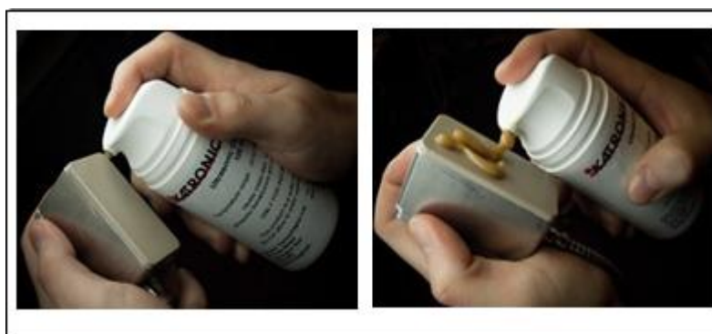
Рисунок 3-5 Нанесение акустического геля
