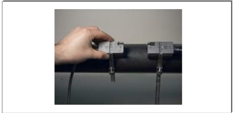
Рисунок 3-6 Корректное расположение датчиков
